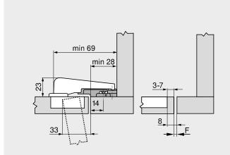
Расстояние до крепления планки: 14 мм Специальная ответная планка под фальшпанель: 199.8130 F Зазор
