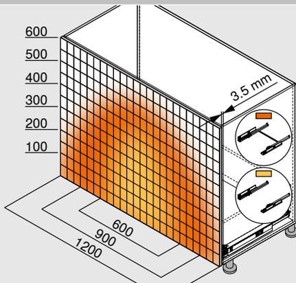
Пример: 550F – 30 кг, номинальная длина NL 500 мм, 4-сторонний ящик с синхронизатором
