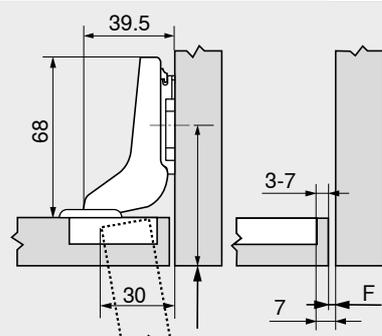
Расстояние (от края) до места крепления ответной планки увеличивается на толщину фасада +1.5 мм
