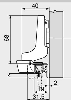
Расстояние (от края) до места крепления ответной планки увеличивается на толщину рамки +2.5 мм
