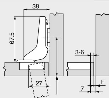
Расстояние (от края) до места крепления ответной планки увеличивается на толщину фасада +1.2 мм
